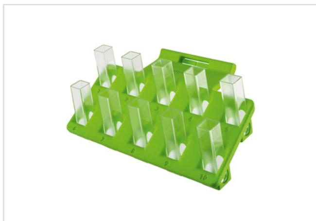
Das Modul ermöglicht ein einfaches Aufbewahren und Fixieren von Küvetten. Durch die spezielle Form der Aussparungen kommen die Seitenflächen der Küvette mit der Halterung nicht in direkten Kontakt. Die angegebenen Maße beziehen sich auf die Schichtdicke der Küvette.
