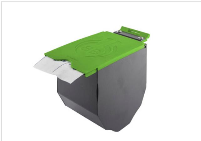
Der Spender für Parafilm® wurde zur Aufnahme von zwei Standardrollen (50 mm) oder einer Doppelrolle (100 mm) entwickelt. Er besteht aus Aluminium und Polyamid 12 und bietet die Möglichkeit einer sauberen und sicheren Aufbewahrung sowie einer einfachen Entnahme von Parafilm® Verschlussfolie.
