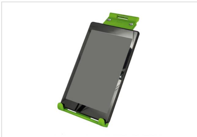
Das Modul ermöglicht ein einfaches Einhängen von Tablets, Smartphones, PDA oder ähnlichen Geräten im Hoch- und Querformat. Durch die Neigung werden eine gute Sicht und eine gute Bedienbarkeit des Displays gewährleistet. Über einen Einrastmechanismus, welcher stufenweise eingestellt werden kann, kann das Modul auf verschiedene Tabletgrößen angepasst werden.
